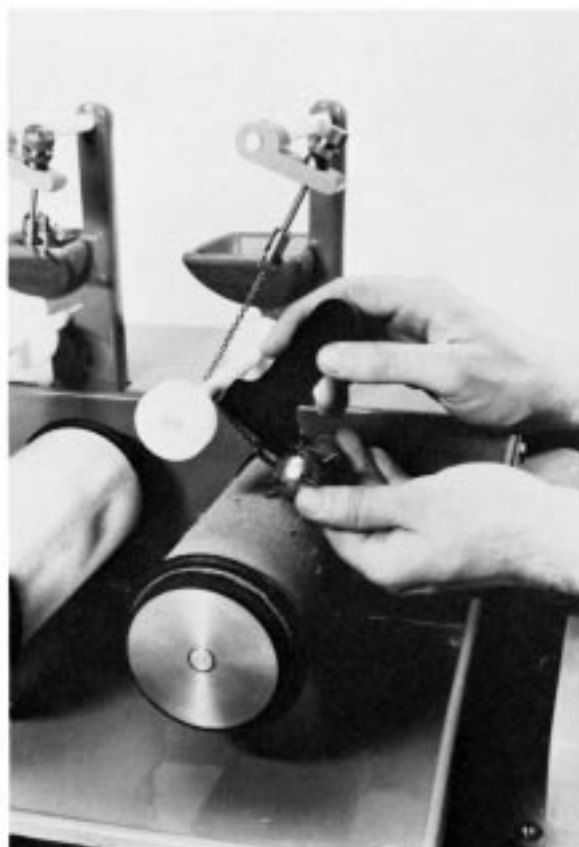
FIG. 6 Adjusting Mace on ICI Snag Tester
